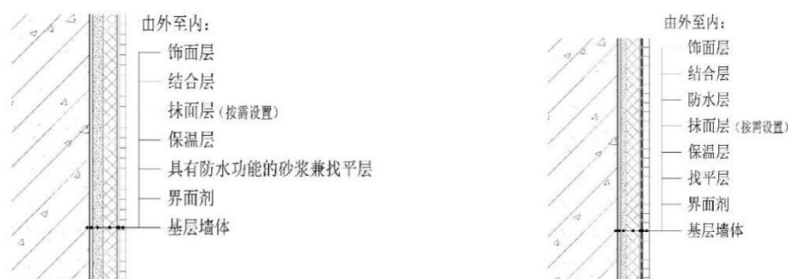
图 5.1.5.2 卫生间有保温墙面防水构造
