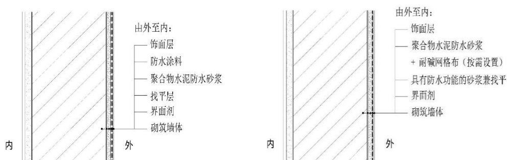
图 3.1.2 框架填充或砌体结构外墙防水构造
